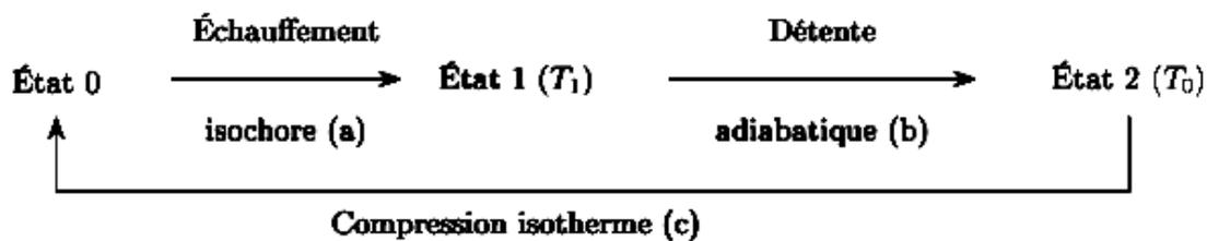
1. Représenter le cycle réalisé dans le diagramme de Watt  $P(V)$ .
