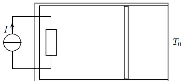
Les parois du compartiment de droite permettent les transferts thermiques, alors que celles du compartiment de gauche ainsi que la membrane sont athermanes. Initialement, l'air (gaz parfait diatomique  $\gamma = 1,4$ ) contenu dans chacun des compartiments est à la température  $T_0 = 300\text{ K}$  et à la pression  $P_0 = 10^5\text{ Pa}$ , l'air extérieur au récipient étant à la température  $T_0$ .
